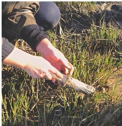
Figura 3 - Remoção da seringa, com sedimento.
