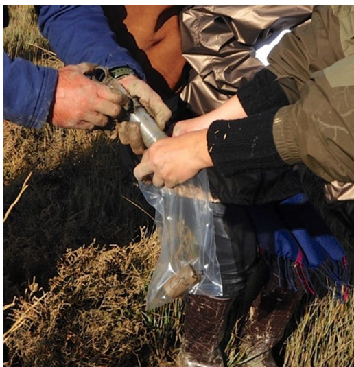
Figura 4 - Amostra de sedimento a ser guardada no saco de amostragem.
