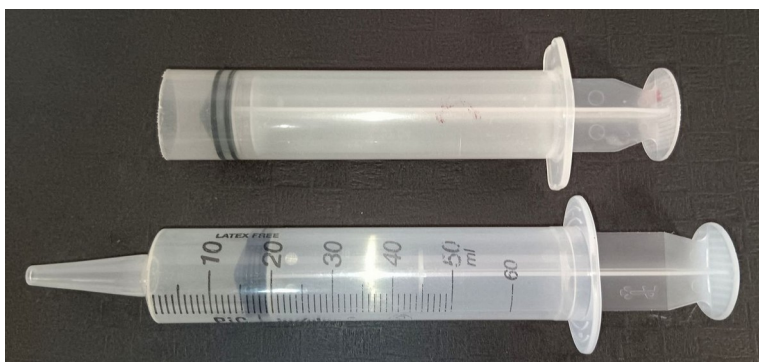
Figura 1 – Seringa para amostrar sedimento, antes (em baixo) e depois de ser cortada (em cima).
