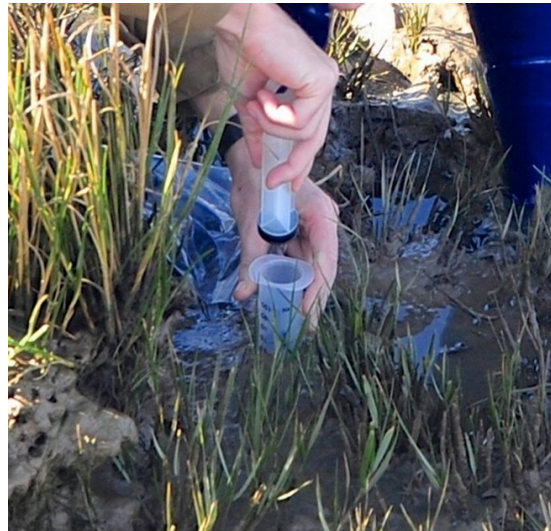
Figura 2 - Inserção da seringa no sedimento.
